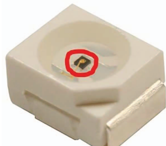
Чип (обведен красным) установлен на подложку с корпусом светодиода 3528 (3,5 на 2,8мм), к чипу припаяны проводки. Люминофора еще нет.
