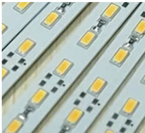
Светодиоды смонтированы на плату из алюминия
